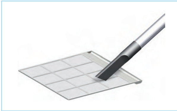
Abb. 16: Reinigung mit dem Staubsauger
