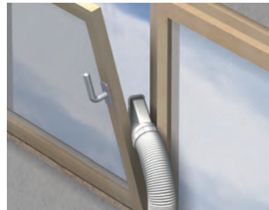
Abb. 11: Abluft bei gekipptem Fenster
